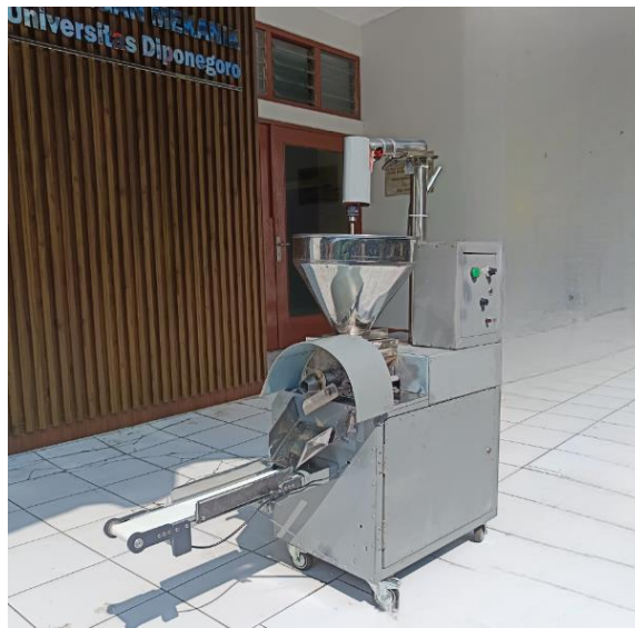
Gambar 4.1 Mesin Pencetak Kue Kacang Otomatis Berbasis Konveyor (Dokumen Pribadi)
