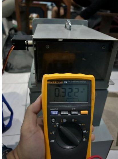
Gambar 4. 6 Pengujian Motor Servo 90^\circ menggunakan multimeter
