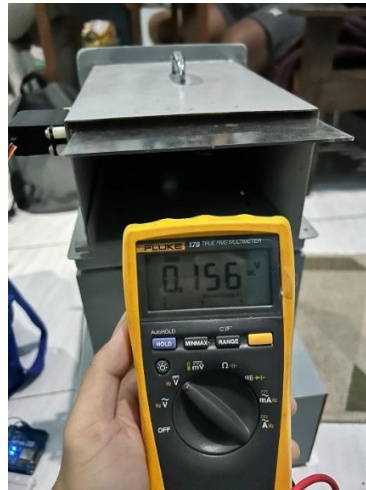
Gambar 4. 5 Pengujian Motor Servo 0^\circ menggunakan multimeter
