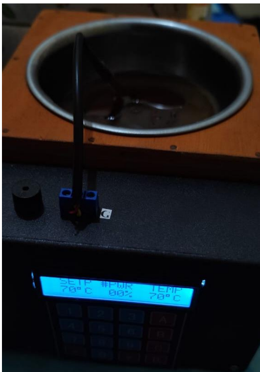
Gambar 5. 5. Malam Batik ketika mencapai set point suhu 70°C
