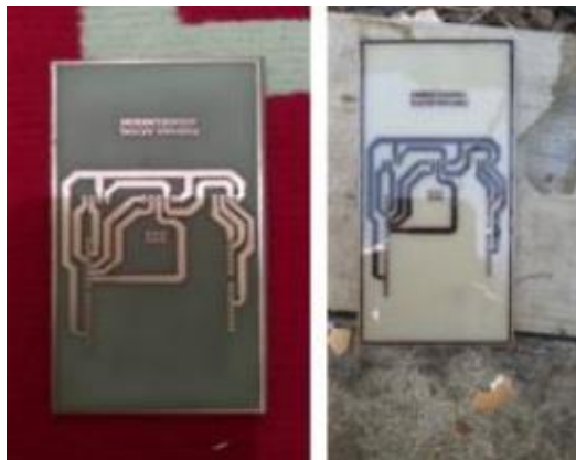
Gambar 4. 18. Hasil pelarutan PCB
