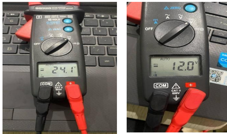
Gambar 4. 4 Tegangan Masukan Dan Tegangan Keluaran
