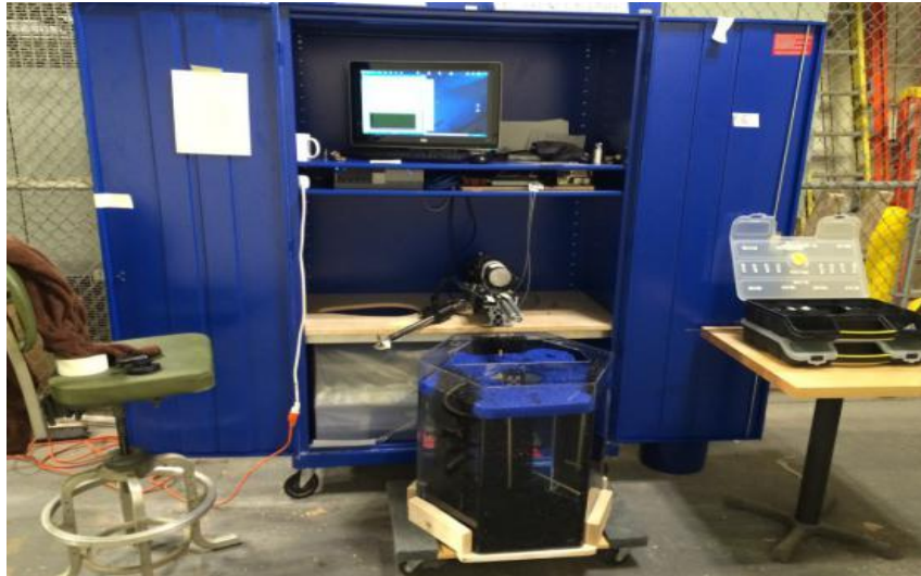
Gambar 2.17 Sharrow Marine Menjalankan Ratusan Desain Prototipe Pada Sebuah Dinamometer Buatan Khusus
