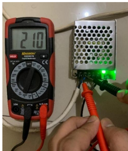
Gambar 4.1 Pengukuran Tegangan Masukan Power Supply
