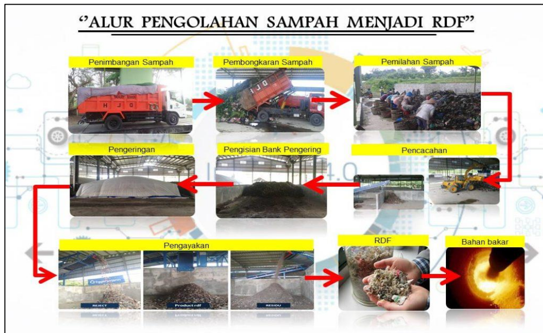
Gambar 2.3. Alur Proses Pengelolaan Sampah Domestik Menjadi Refuse Derived Fuel (RDF)
