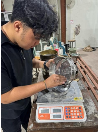
Gambar 3. 9 Penimbangan dari Saringan
