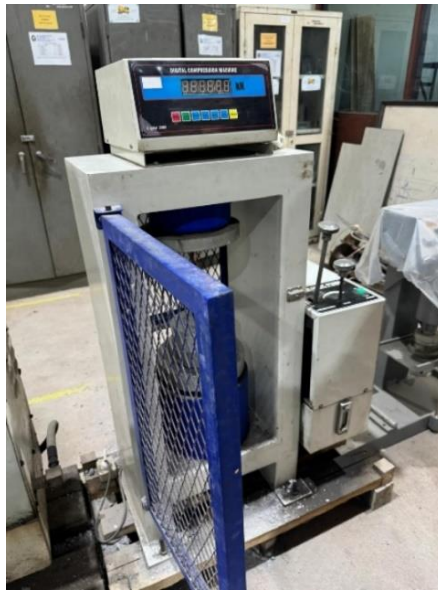
Gambar 3. 31 Peletakan Benda Uji di Alat Uji Kuat Tekan
