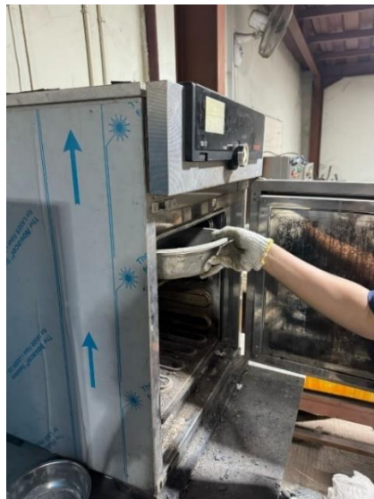
Gambar 3. 12 Pengeringan Sample dalam Oven
