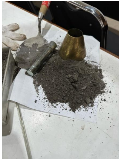
Gambar 3. 15 Hasil Tes Menggunakan Kerucut Kuningan
