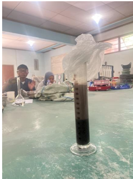
Gambar 3. 18 Gelas Ukur diisi Pasir Lolos Saringan No. 4
