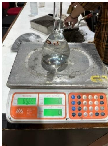
Gambar 3. 16 Penimbangan Labu Ukur diisi Air
