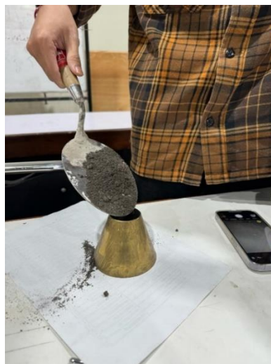
Gambar 3. 14 Pengetesan Menggunakan Kecurut Kuningan
