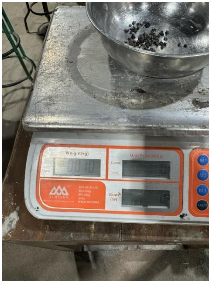
Gambar 3. 10 Perhitungan Berat Agregat
