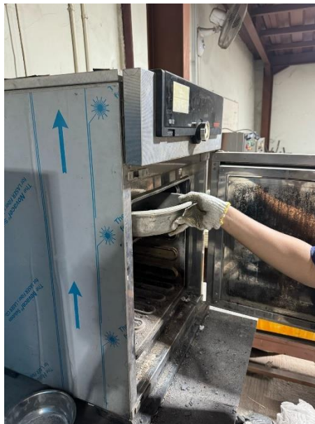
Gambar 3. 6 Pengambilan Pasir dari Oven
