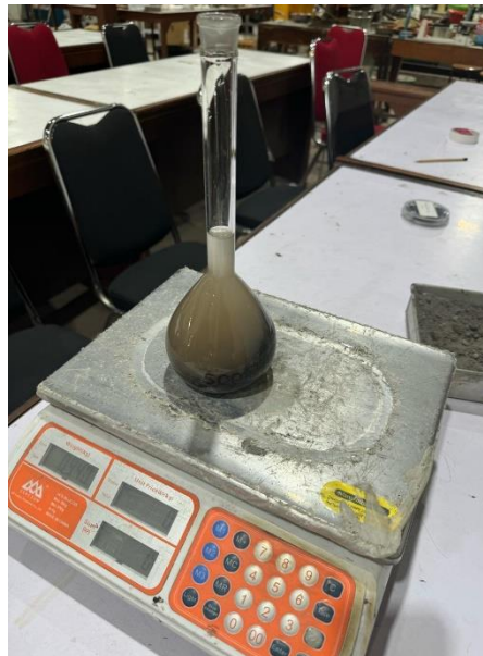
Gambar 3. 17 Penimbangan Labu Ukur di isi Pasir dan Air
