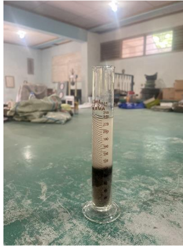
Gambar 3. 19 Pengamatan Tinggi Endapan Lumpur dan Tinggi Endapan Pasir
