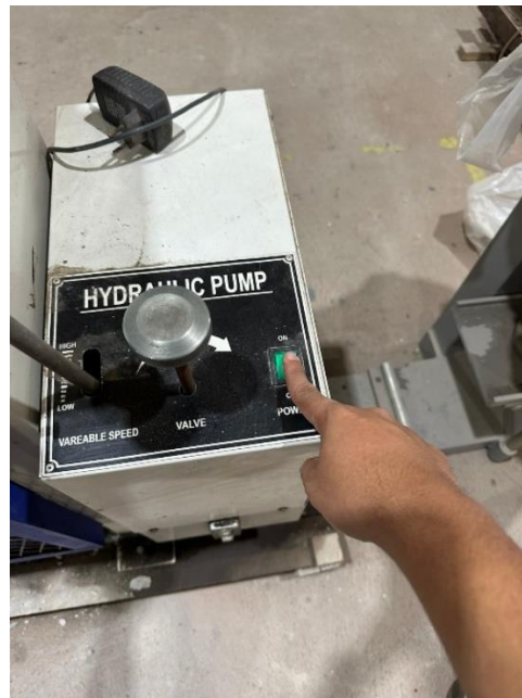
Gambar 3. 34 Alat Uji Kuat Tekan Dinyalakan
