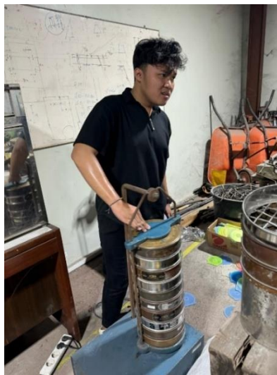
Gambar 3. 8 Proses Penyaringan Pasir
