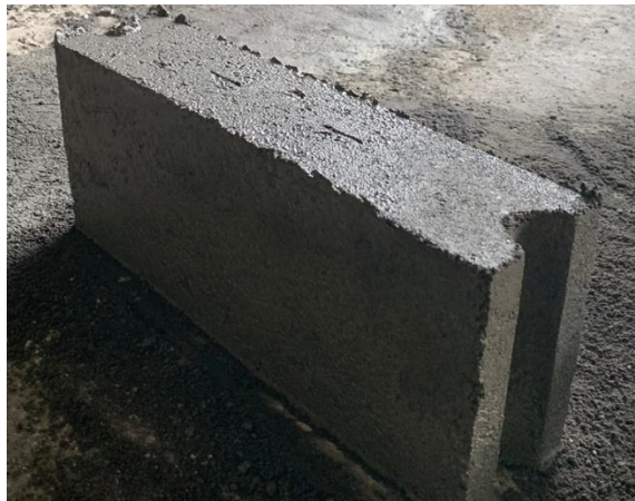
Gambar 3.23 Pelepasan cetakan batako Sumber: Dokumen Pribadi
