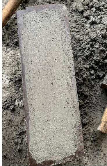
Gambar 3.22 Proses pencetakan batako Sumber: Dokumen Pribadi
