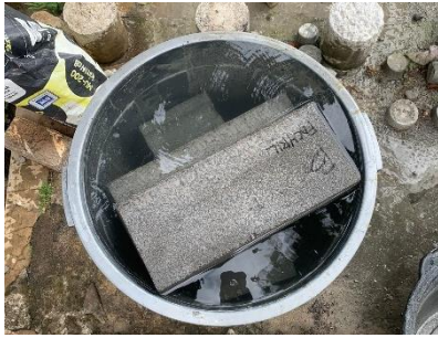
Gambar 3.25 Uji daya serap air Sumber: Dokumen Pribadi
