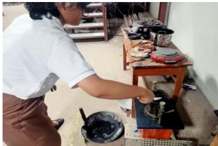
Gambar 3. 56 Memasukan Campuran kedalam mold Sumber : Penelitian (2023)
