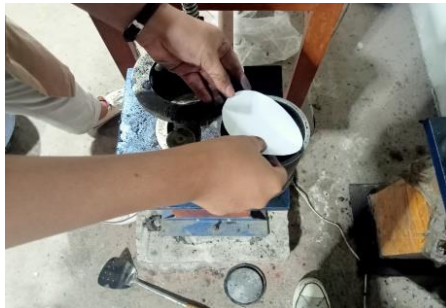
Gambar 3. 57 Meletakkan Kertas Saringan di atas Permukaan Benda Uji Sumber : Penelitian (2023)
