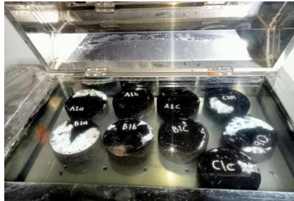
Gambar 3. 60 Perendaman Benda Uji di Waterbath Sumber : Penelitian (2023)
