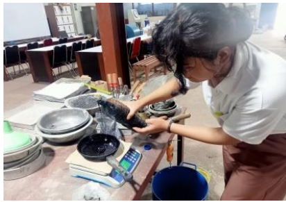
Gambar 3. 53 Pencampuran Zat Aditif Anti Stripping Agent dengan Aspal Sumber : Penelitian (2023)
