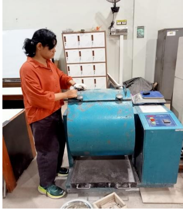
Gambar 3. 21 Pengujian Abrasi menggunakan Mesin Los Angeles Sumber : Penelitian (2023)
