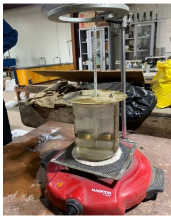
Gambar 3. 12 Pengujian Titik Lembek Aspal Sumber : Penelitian (2023)
