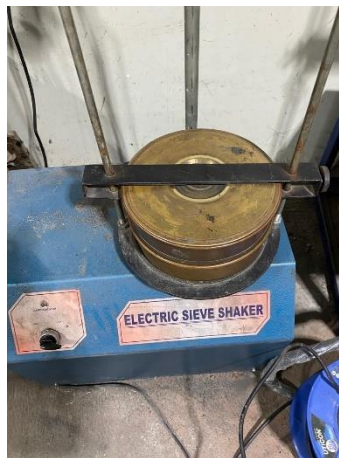
Gambar 3. 22 Penyaringan Bahan dengan Shieve Shaker
