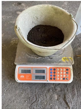
Gambar 3. 25 Penimbangan Agregat Halus
