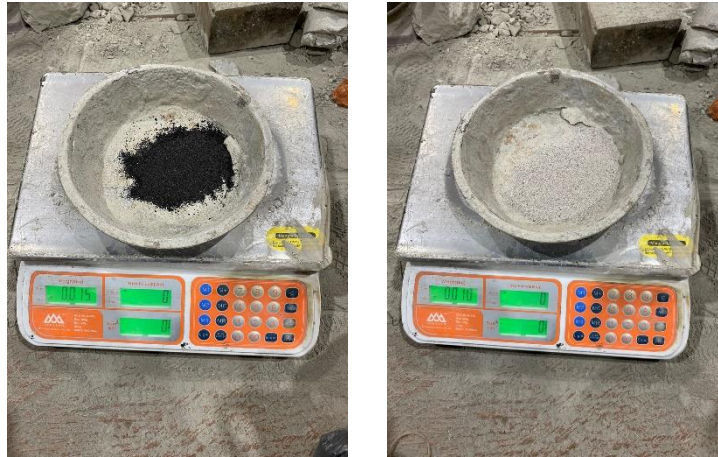
Gambar 3. 24 Penimbangan Abu Boiler Kelapa Sawit & Abu Sekam Padi
