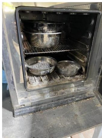
Gambar 3. 20 Proses Mengoven Bahan Penyusun Paving block
