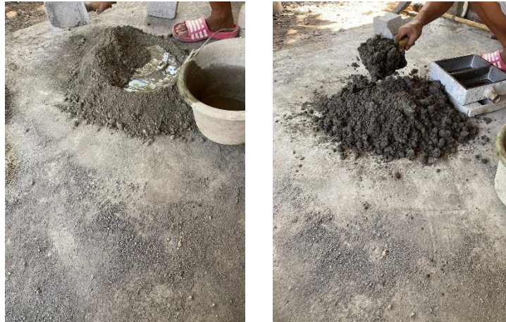
Gambar 3. 28 Pencampuran Bahan - Bahan Penyusun Paving Block
