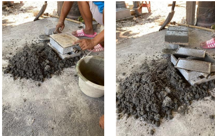
Gambar 3. 31 Melepaskan Campuran dari Cetakan Paving Block
