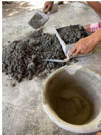
Gambar 3. 29 Memasukan Campuran ke Dalam Cetakan Paving Block
