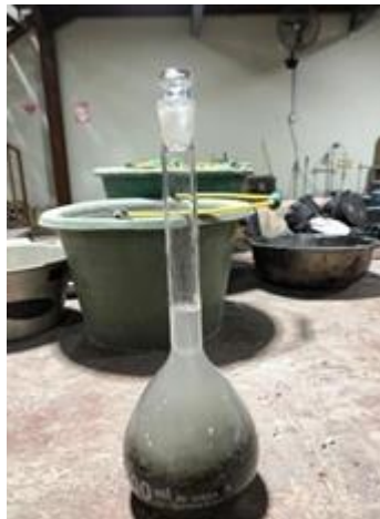
Gambar 3.21 Pengujian Berat Jenis Filler & Penyerapan
