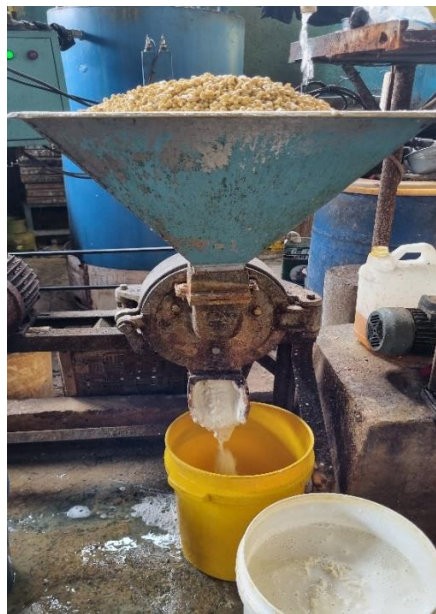
Gambar 2.5 Proses penggilingan kedelai menjadi bubur kedelai
