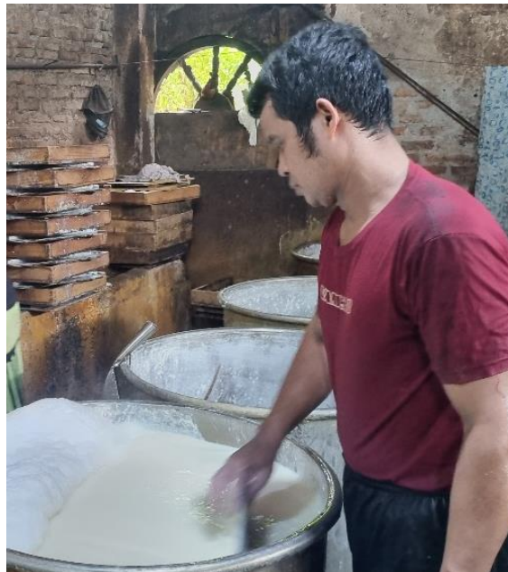
Gambar 2.10 Pencampuran sari kedelai dengan air biang cuka
