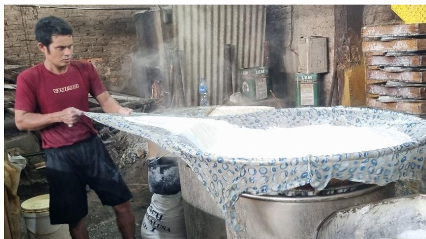
Gambar 2.7 Proses penyaringan Sari Kedelai
