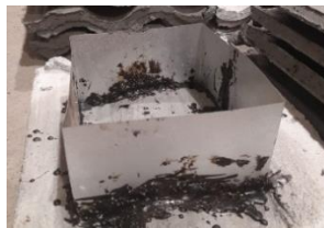
Gambar 3. 63 Meletakkan seng di atas benda uji
