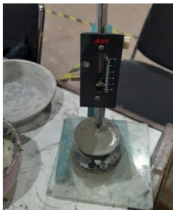
Gambar 3. 45 Mengamati penurunan jarum (Sumber : Dokumentasi Penulis)
