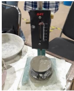
Gambar 3. 44 Menempatkan jarum vicat di permukaan (Sumber : Dokumentasi Penulis)
