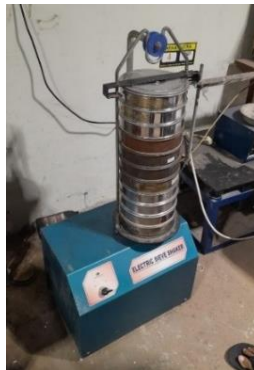
Gambar 3. 33 Menggetarkan saringan (Sumber : Dokumentasi Penulis)
