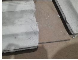
Gambar 3. 56 Pengujian kerataan (Sumber : Dokumentasi Penulis)
