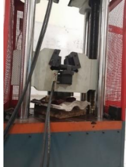
Gambar 3. 59 Pengujian kuat lentur (Sumber : Dokumentasi Penulis)
