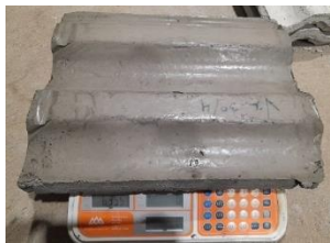
Gambar 3. 62 Penimbangan genteng beton basah
