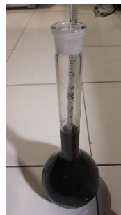
Gambar 3. 46 Mengukur suhu piknometer yang ditambah abu sekam dan air
