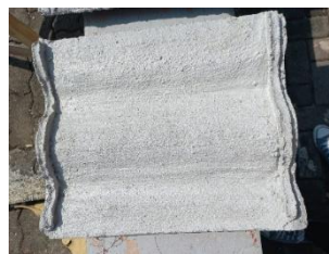
Gambar 3. 51 Genteng Beton Siap Uji
