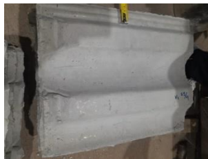
Gambar 3. 54 Mengukur lebar penumpangan benda uji
