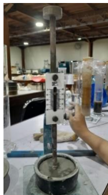
Gambar 3. 43 Mengamati penurunan jarum
