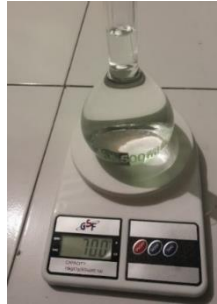
Gambar 3. 37 Mengisi piknometer dengan air (Sumber : Dokumentasi Penulis)
