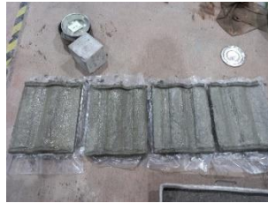
Gambar 3. 50 Mengeringkan Genteng Beton
