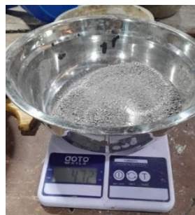
Gambar 3. 38 Menimbang pasir yang sudah dioven (Sumber : Dokumentasi Penulis)
