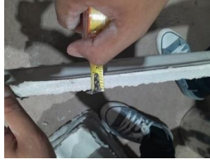
Gambar 3. 53 Mengukur tebal benda uji
