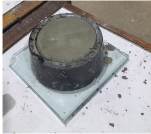
Gambar 3. 41 Memasukkan adonan ke mol
