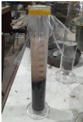
Gambar 3. 24 Menutup gelas ukur (Sumber : Dokumentasi Penulis)
