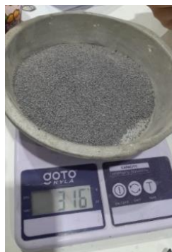
Gambar 3. 34 Menimbang agregat halus (Sumber : Dokumentasi Penulis)
