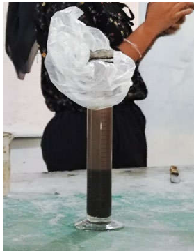
Gambar 3. 18 Menutup Gelas Ukur Dengan Plastik
