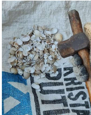
Gambar 3. 25 Cangkang Kerang Dihancurkan Dengan Palu
