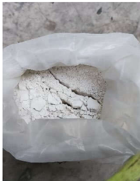
Gambar 3. 26 Serbuk Cangkang Kerang Lolos Saringan no.200
