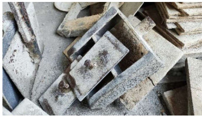
Gambar 3. 8 Cetakan Paving Block
