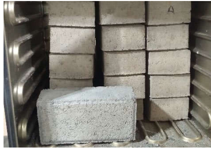
Gambar 3. 37 Benda Uji Dioven
