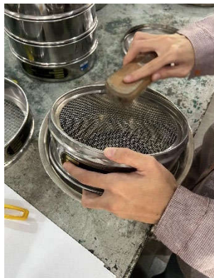
Gambar 3. 15 Mengambil Pasir Tertahan Tiap Saringan
