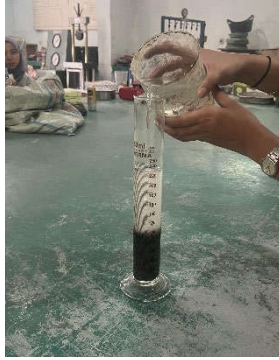
Gambar 3. 17 Menambahkan Air Ke Dalam Gelas Ukur Berisi Pasir
