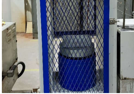
Gambar 3. 35 Benda Uji Di Dalam Alat Kuat Tekan
