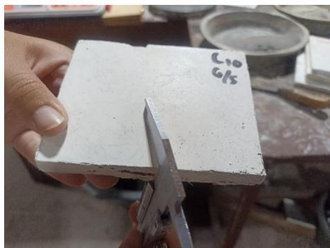
Gambar 3. 22 Pengukuran Tebal Benda Uji
