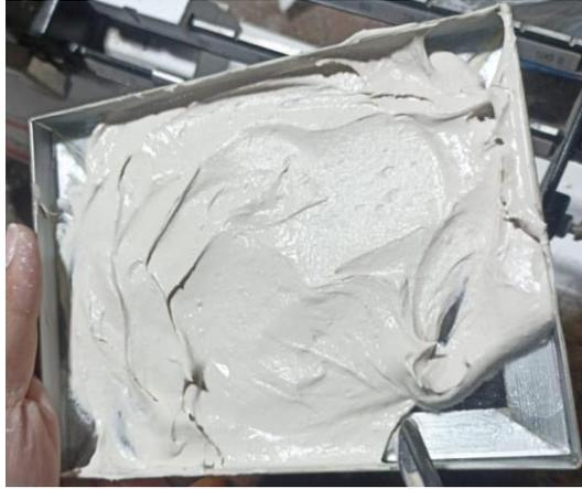
Gambar 3. 11 Menuangkan Bahan ke Bekisting
