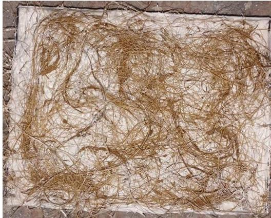
Gambar 3. 12 Penyusunan Serat Kelapa di Atas Adonan Gypsum
