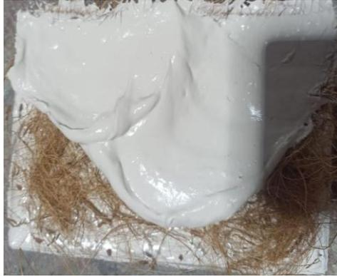
Gambar 3. 13 Pelapisan Adonan Gypsum ke 2
