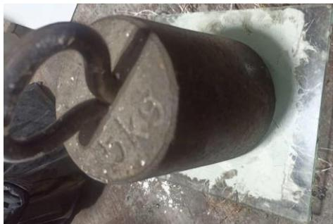
Gambar 3. 15 Penutupan Benda Uji
