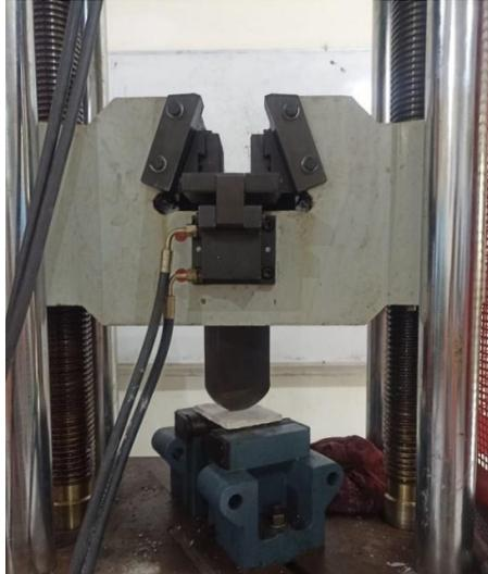
Gambar 3. 29 Peletakkan Benda Uji Pada Alat UTM
