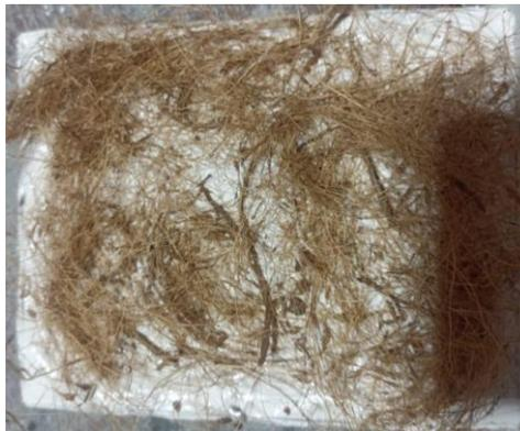
Gambar 3. 14 Penyusunan Serat Kelapa Lapisan ke 2
