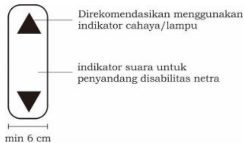
Gambar 2. 28 Indikator lif (naik atau turun) (Sumber : Permen PUPR No.14 Tahun 2017)
