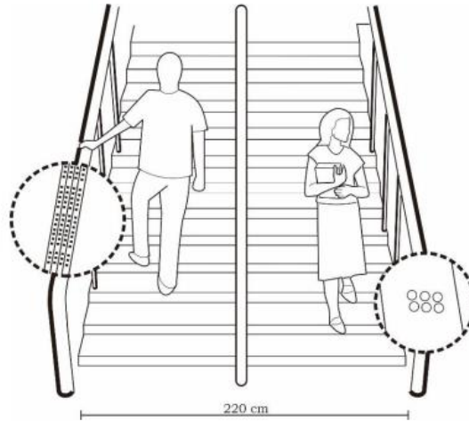
Gambar 2. 20 Tangga dengan huruf braille pada interval tertentu di sisi atas handrail untuk menunjukkan posisi anak tangga
