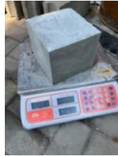
Gambar 3. 56 Timbang benda uji
