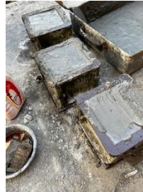
Gambar 3. 44 Mencetak bata ringan
