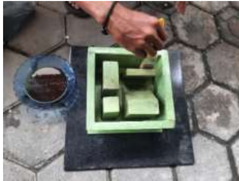
Gambar 3.23 Mengolesi Cetakan (Sumber: Dokumentasi Penulis)
