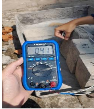
Gambar 3. 48 Uji termokopel pada sisi panas
