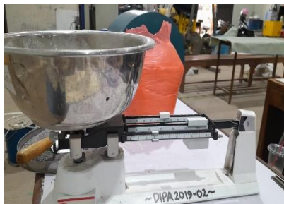
Gambar 3. 24 Penimbangan pasir setelah sieve shaker
