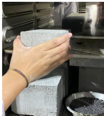
Gambar 3. 45 Memasukan benda uji ke dalam oven
