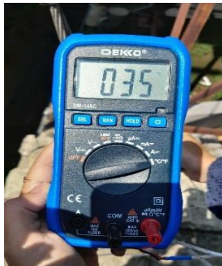
Gambar 3. 49 Uji termokopel pada sisi tidak panas
