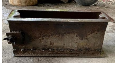
Gambar 3. 5 Cetakan Batako Konvensional
