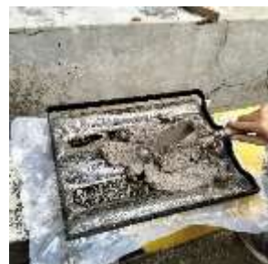
Gambar 3. 67 Menuangkan Adonan ke Cetakan (Sumber : Dokumentasi Penulis)
