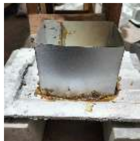
Gambar 3. 83 Perletakan Seng dan Pelapisan Lilin Gondorukem
