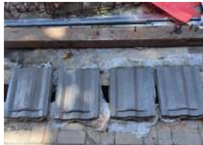
Gambar 3. 69 Pengeringan Benda Uji (Sumber : Dokumentasi Penulis)
