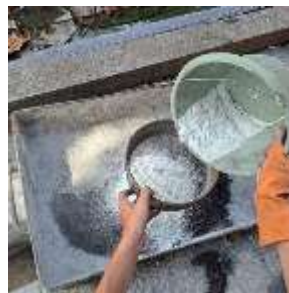
Gambar 3. 55 Serbuk Kaca Lolos dengan Saringan 4,75 mm
