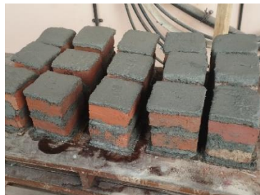
Gambar 3. 16 Pelapisan Capping Atas Benda Uji Menggunakan Mortar Dan Proses Pengeringan
