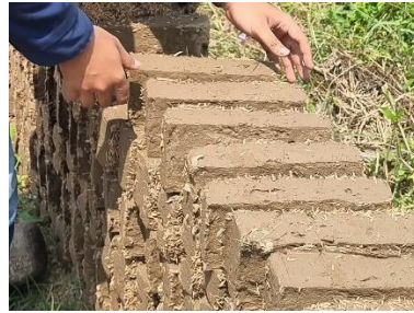
Gambar 3. 8 Proses Pengeringan Bata Sebelum Pembakaran
