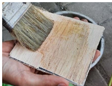
Gambar 3. 12 Pengolesan Plywood Dengan Oli
