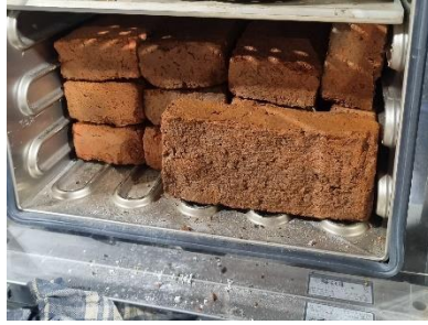
Gambar 3. 18 Tahap Pengeringan Benda Uji
