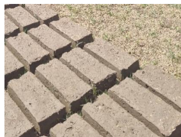
Gambar 3. 7 Proses Penjemuran Batu Bata Merah
