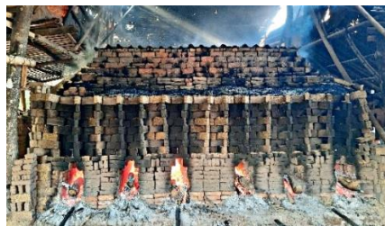
Gambar 3. 9 Proses Pembakaran Batu Bata Merah
