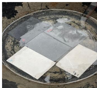
Gambar 3. 36 Proses Perendaman Benda Uji
