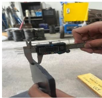
Gambar 3. 35 Pengukuran Tebal Benda Uji
