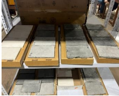
Gambar 3. 30 Benda Uji Dalam Suhu Ruang
