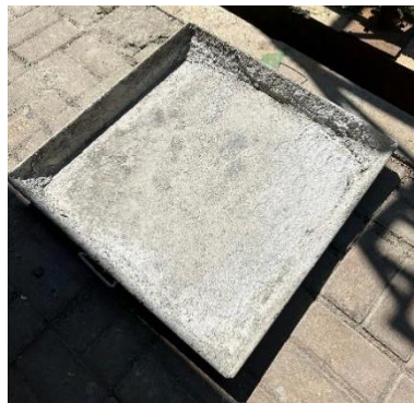
Gambar 3. 7 Bak Pengaduk Beton
