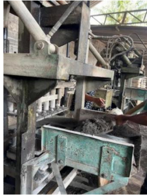
Gambar 3. 53 Adukan paving block dalam cetakan
