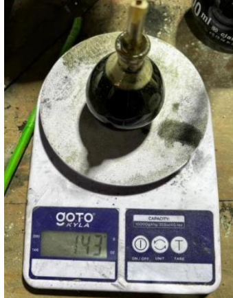
Gambar 3. 25 Penimbangan picknometer + sampel Sumber : Dokumentasi Pribadi
