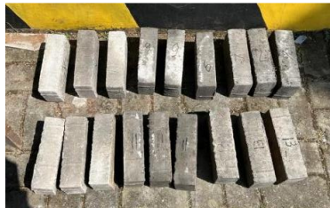
Gambar 3. 57 Paving block setelah didiamkan selama sehari
