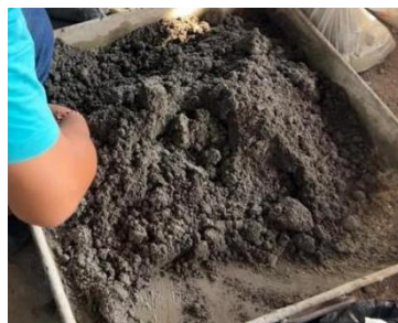
Gambar 3. 52 Hasil akhir adukan paving block
