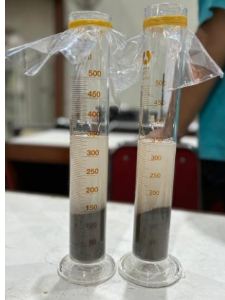
Gambar 3. 30 Pasir + NaOH + air dalam gelas ukur
