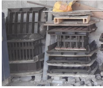
Gambar 3. 6 Cetakan paving block
