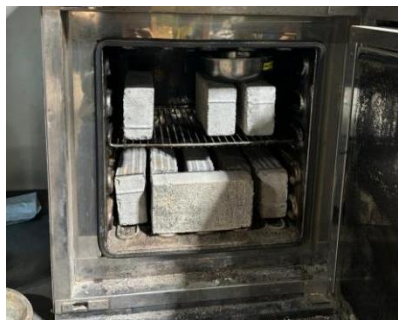
Gambar 3. 63 Proses Pengeringan pada Oven
