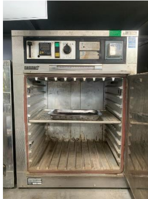
Gambar 3. 18 Proses pengeringan pasir
