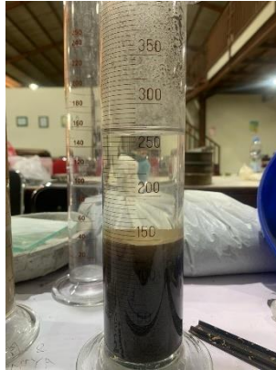
Gambar 3. 26 Hasil pengujian larutan NaOH kedalam pasir
