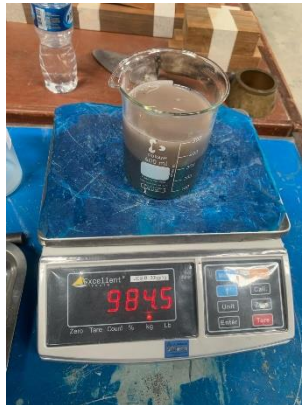
Gambar 3. 20 Proses penimbangan gelas ukur berisi pasir dan air
