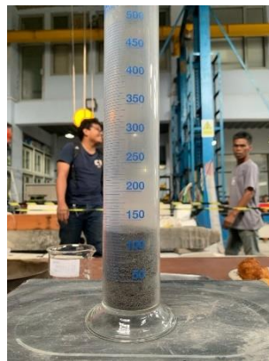
Gambar 3. 21 Proses pengukuran tinggi pasir
