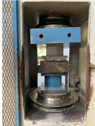
Gambar 3. 40 Pengujian kuat tekan paving block
