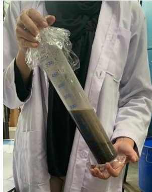
Gambar 3. 22 Proses pengocokan pasir dan air
