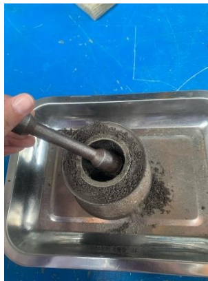
Gambar 3. 19 Proses penumbukkan pasir
