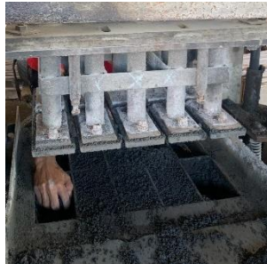
Gambar 3. 7 Cetakan Paving Block
