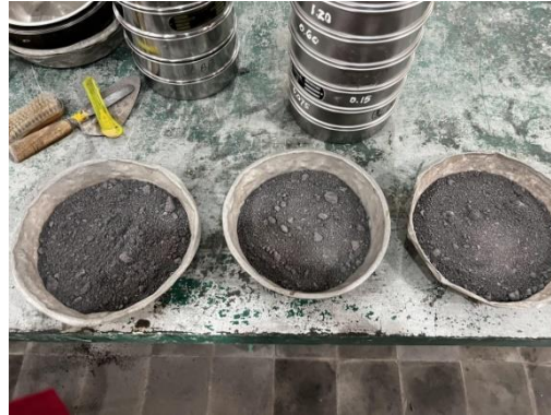
Gambar 3.27 Material Uji Modulus Kehalusan (Sumber : Dokumentasi Penulis)
