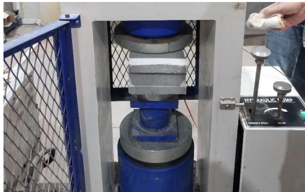
Gambar 3.54 Peletakan Bata Beton pada Mesin
