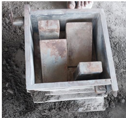
Gambar 3.50 Cetakan Ventilation Block
