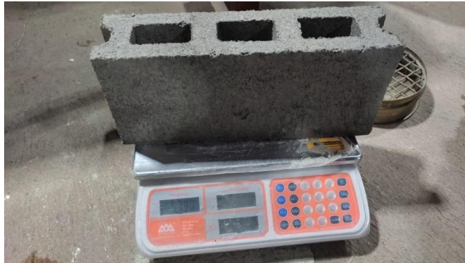
Gambar 3.58 Penimbangan Bata Beton dengan Kondisi Jenuh Air
