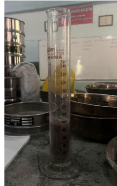
Gambar 3.35 Pemindahan Pasir ke Dalam Gelas Ukur
