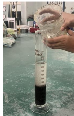
Gambar 3.36 Pengisian Air ke dalam Gelas Ukur
