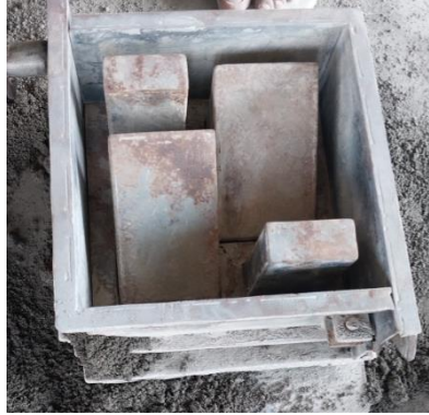
Gambar 3.3 Cetakan Ventilation Block
