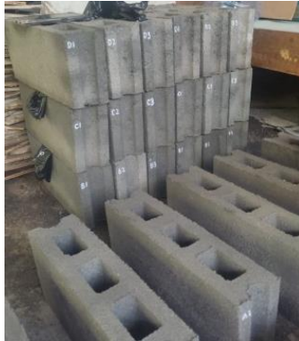
Gambar 3.47 Penyimpanan dan Perawatan Bata Beton
