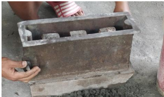
Gambar 3.44 Persiapan Cetakan Bata Beton
