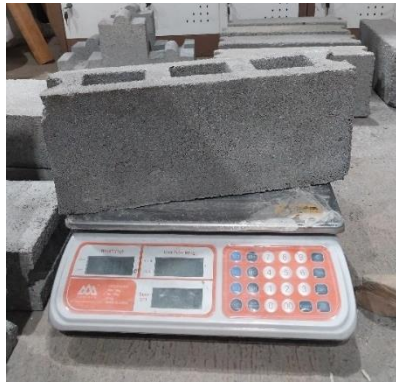
Gambar 3.53 Penimbangan Benda Uji
