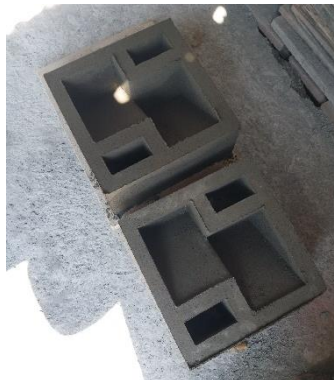
Gambar 3.52 Penyimpanan dan Perawatan Ventilation Block
