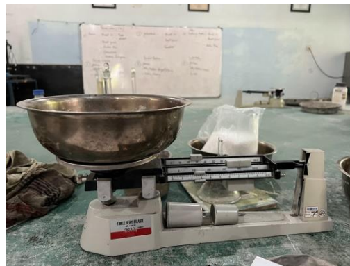
Gambar 3.30 Penimbangan Material Setelah Dikeringkan
