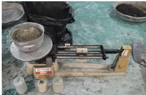
Gambar 3.28 Penimbangan Material (Sumber : Dokumentasi Penulis)
