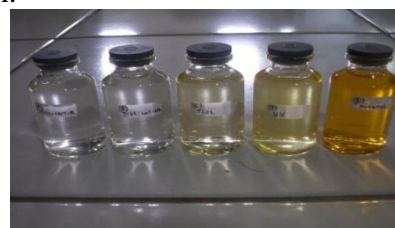
Gambar 7. Warna sampel hasil fotodegradasi selama 12 jam: (a) Lapisan tipis nanokomposit TiO 2 /CNT refluks, (b) Lapisan tipis nanokomposit TiO 2 /CNT non refluks, (c) Lapisan tipis TiO 2 (d) UV (e) kontrol
