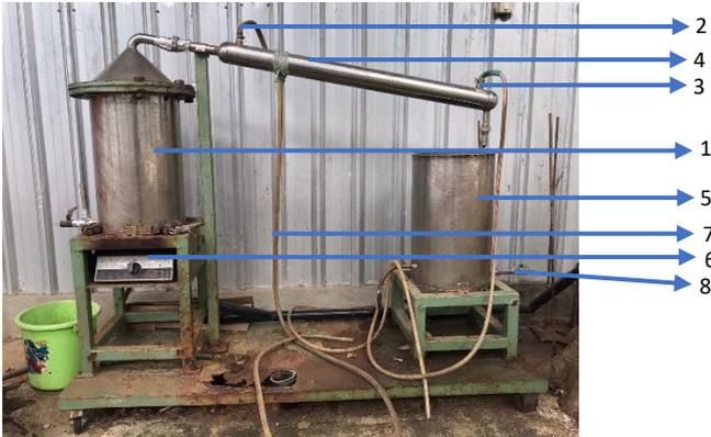
Alat pembuatan minyak atsiri (Distilasi), terdiri atas:
