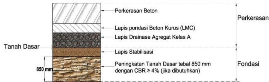
**Gambar 2.3c Perkerasan Kaku pada Tanah Galian**
