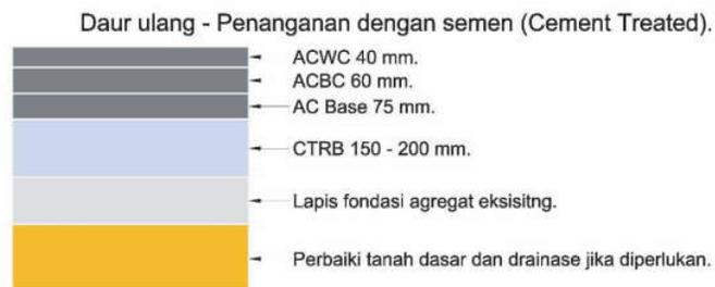
**Gambar 2. 4c Rehabilitasi Struktur Perkerasan dengan Daur Ulang**
