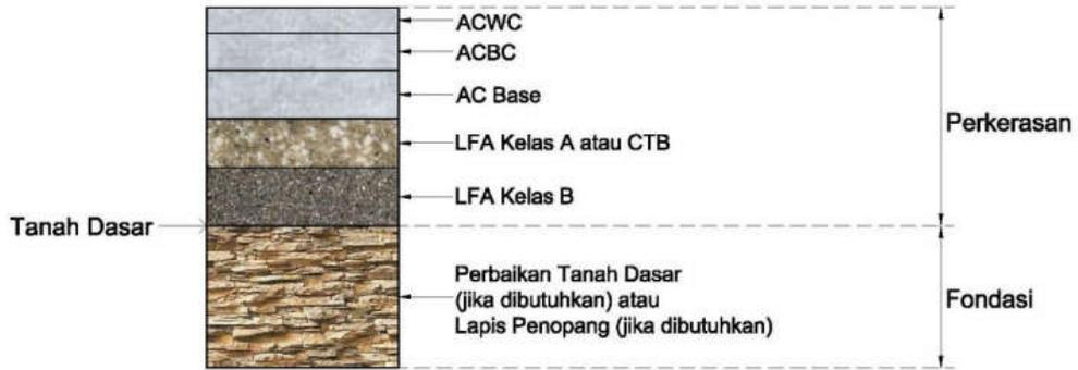
**Gambar 2. 2a Perkerasan Lentur pada Permukaan Tanah Asli (*At Grade*)**
