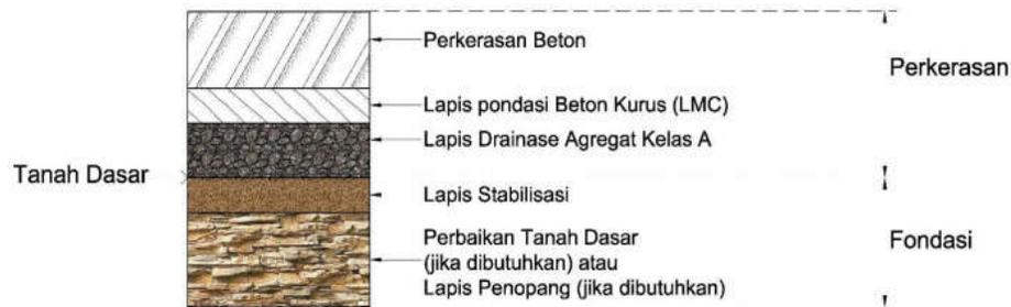
Gambar 2. 3a Perkerasan Kaku pada Permukaan Tanah Asli (*At Grade*)
