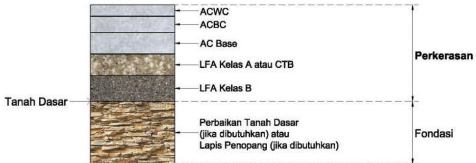
**Gambar 2. 2c Perkerasan Lentur pada Tanah Galian**
