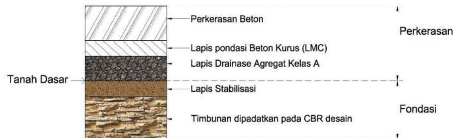
Gambar 2.3b Perkerasan Kaku pada Tanah Timbunan
