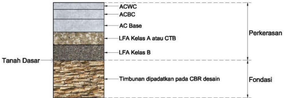
**Gambar 2. 2b Perkerasan Lentur pada Tanah Timbunan**
