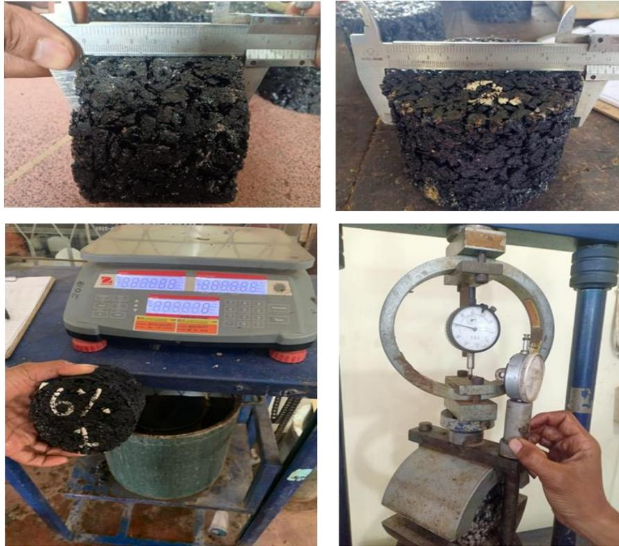
Gambar 3.5 (a) Pengukuran tinggi sampel, (b) Pengukuran diameter sampel, (c) Penimbangan sampel dalam air, (d) Pengujian Stabilitas Marshall
