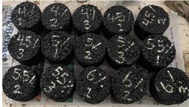
Gambar 3.4 Sampel yang dipadatkan dengan pemadat Marshall
