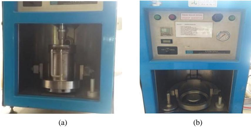
Gambar 3.7 (a). Pemadatan sampel, (b). Alat Pemadat Gyratory
