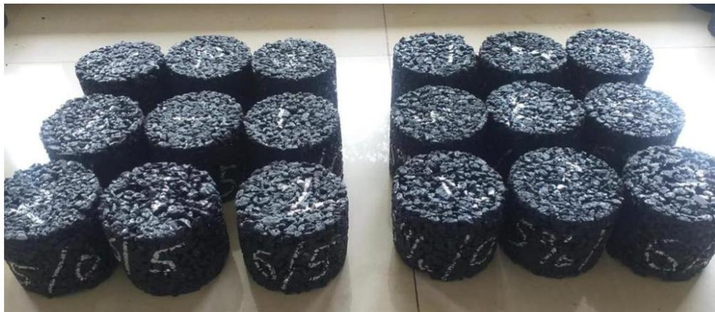
Gambar 3.8 Sampel yang dipadatkan dengan gyratory
