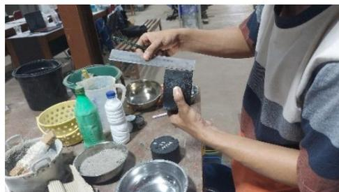
**Gambar 3.27** Pengukuran Ketebalan / Tinggi Benda Uji
