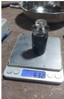
**Gambar 3.13** Penimbangan Berat Aspal dengan *Picnometer*
