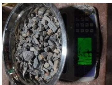
**Gambar 3.5** Penimbangan Material Lolos No.200 pada Agregat Kasar
