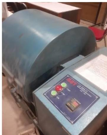
**Gambar 3.3** Pengujian Keausan *Los Angeles*
