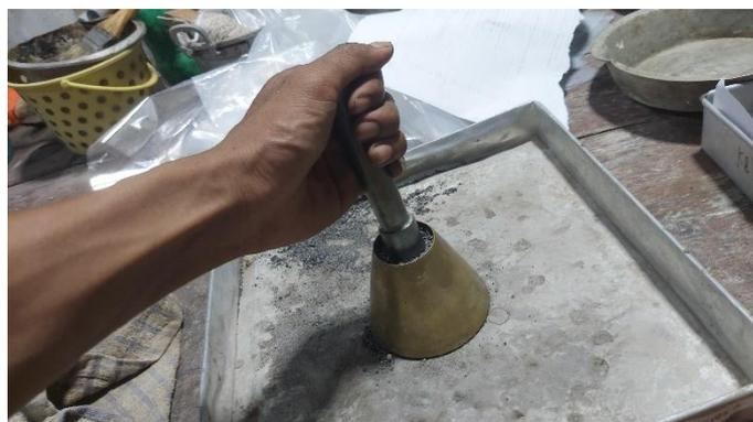
**Gambar 3.7** Pengujian SSD Sampel Agregat Halus
