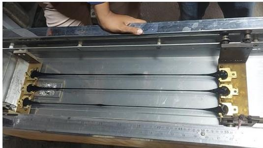
**Gambar 3.16** Pengujian Daktilitas Aspal
