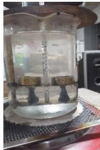
**Gambar 3.15** Pengujian Titik Lembek Aspal
