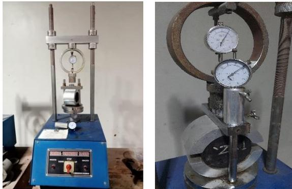
**Gambar 3.30** Pengujian dengan Alat *Marshall*
