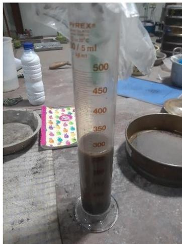
**Gambar 3.10** Pengukuran Skala Nilai Setara Pasir
