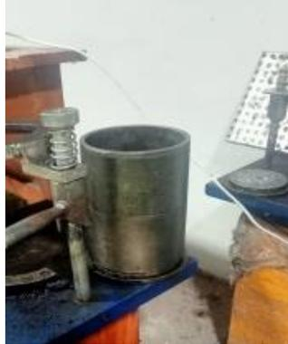
**Gambar 3.20** Cetakan Sampel Benda Uji
