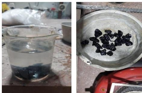
**Gambar 3.4** Pengujian Kelekatan Agregat - Aspal
