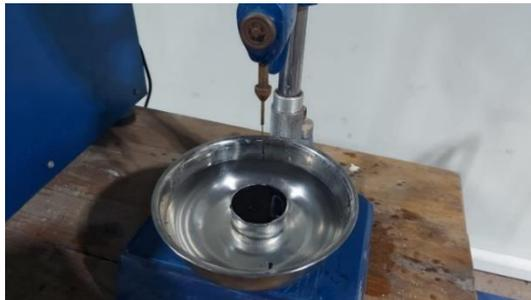
**Gambar 3.14** Pengujian Penetrasi Aspal keras
