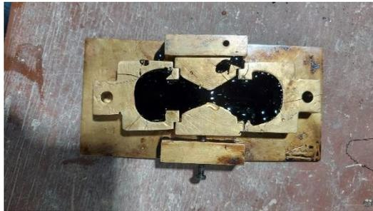
**Gambar 3.17** Benda Uji Pengujian Daktilitas
