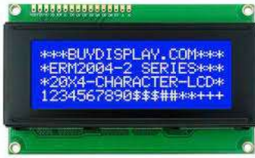
Gambar 2.5. Bentuk Fisik Display LCD 20x4 (Sumber : bukalapak.com, 2021)
