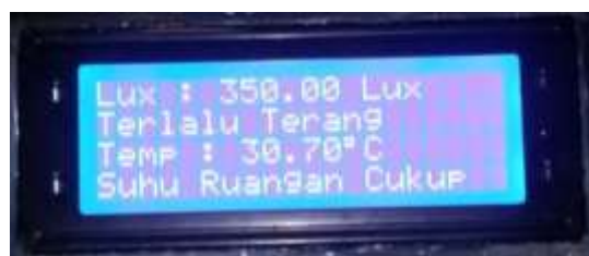
Gambar 4.3 Pengujian LCD terhadap Sensor BH1750 dan DHT 22
