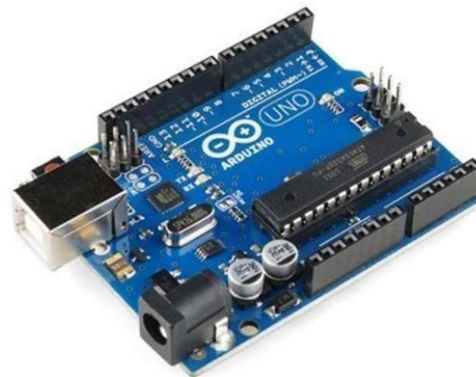
Gambar 2.13 Papan Arduino uno
