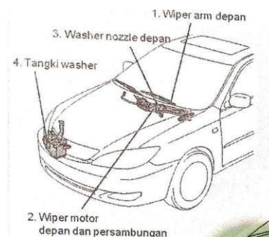
Gambar 2.2 Sistem wiper pada kaca depan
