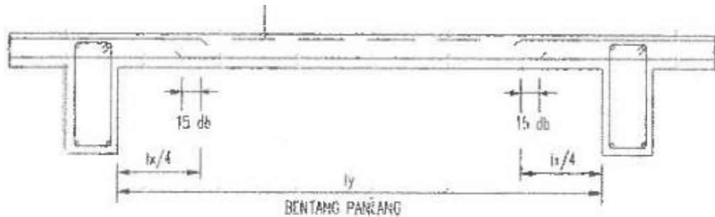
Gambar 3. 16 Potongan Melintang Pelat Lantai Tipe S12A
