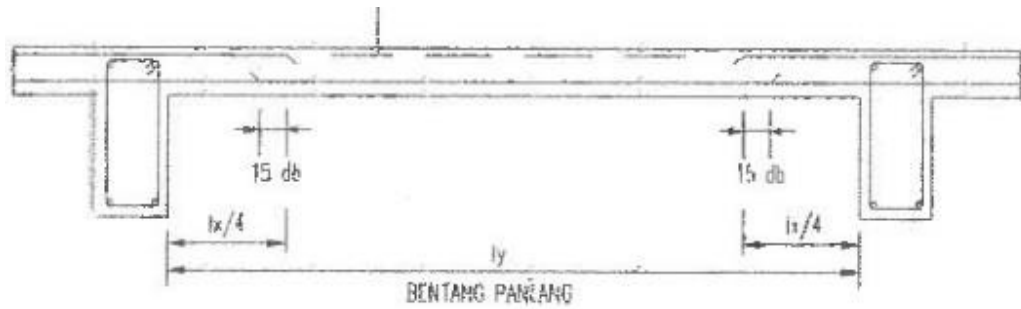
Gambar 3. 24 Potongan Melintang Pelat Lantai Tipe S12C
