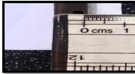
Gambar 3. 16 Kedalaman lubang dari permukaan 0.5mm.
