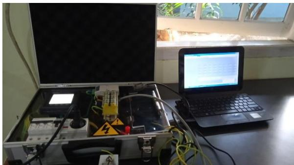
Gambar 3. 25 Rangkaian *Kit Power Meter 5350* Schneider
