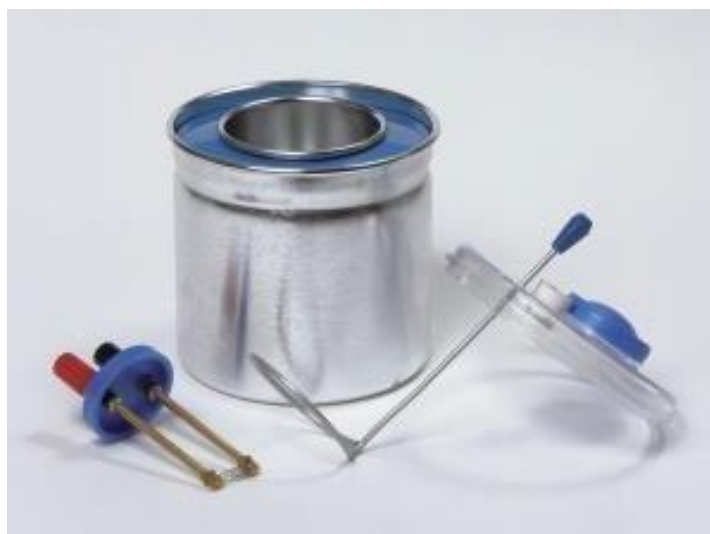
Gambar 2.11. Kalorimeter ukuran 75mm x 50 mm (Setiawan, D. 2018)
