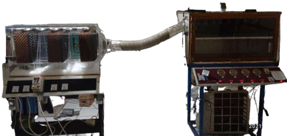
Gambar 3.22 . Penyambungan Test Bed AC dengan Evaporative cooler
