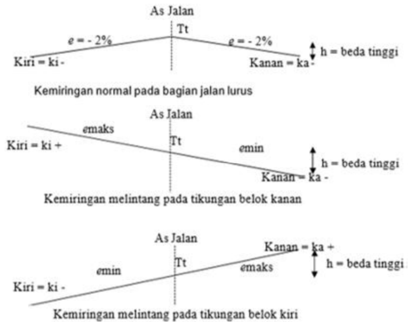
Gambar 2. 9 Superelevasi Sumber : Bina Marga, 1997
