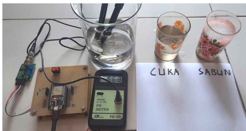
**Gambar 4. 1** Pengujian modul sensor pH dengan modul PH-4502C
