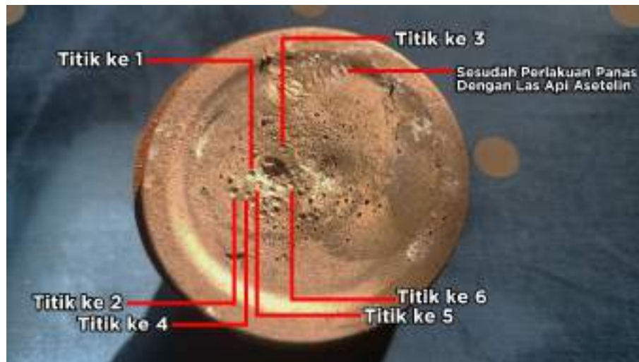
Gambar 4.18 Permukaan piston yang dilakukan indentasi setelah diberikan perlakuan panas
