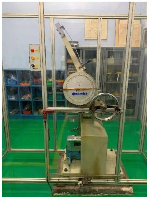
Gambar 3. 4 Alat Uji Impak
