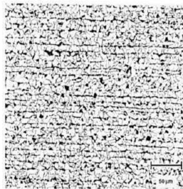
Gambar 2. 5 Struktur mikro ferrite
