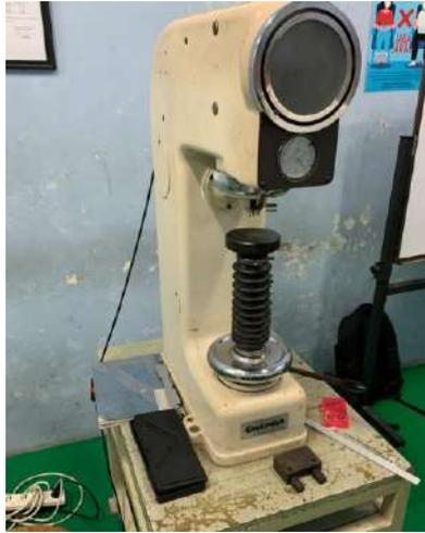
Gambar 3. 5 Mesin Uji Kekerasan Vickers
