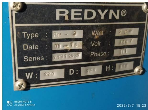
Gambar 3.4 Spesifikasi Tungku Heat Treatment
