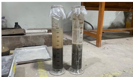
Gambar 3.12 Pengujian Sand Equivalent
