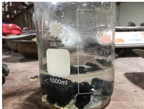
Gambar 3.8 Pengujian Kelekatan Agregat terhadap Aspal Sumber: Peneliti (2023)
