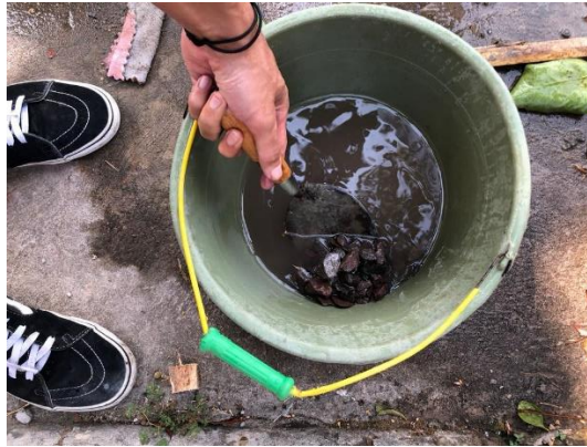
Gambar 3.11 Pengovenan Agregat Tertahan Saringan No. 200
