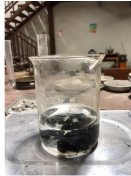
Gambar 3.5 Pengujian Berat Jenis Aspal Sumber: Peneliti (2023)
