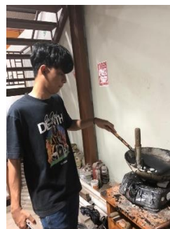
Gambar 3.26 Penambahan Aspal dan Limbah beton
