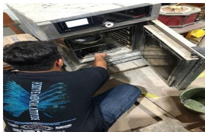
Gambar 3.9 Pengovenan Agregat Tertahan Saringan No. 200
