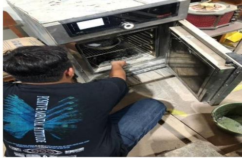
Gambar 3.25 Pemanasan Agregat dan Filler
