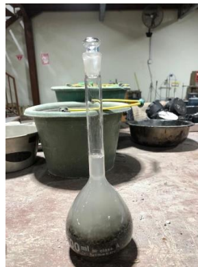
Gambar 3.13 Pengujian Berat Jenis Filler
