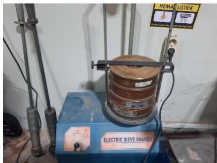
Gambar 3. 29 Pengayakan Abu Vulkanik dengan Shieve Saker (Sumber : Dokumentasi Penulis)
