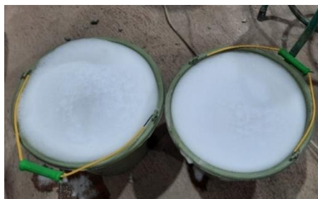
Gambar 3. 38 Campuran Air dan Foam Agent yang sudah mengeluarkan busa (Sumber : Dokumentasi Penulis)
