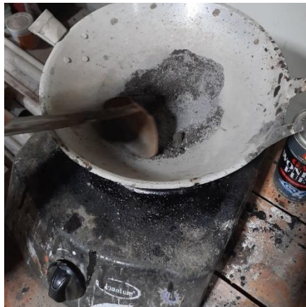
Gambar 3. 31 Mengeringkan Pasir dengan Kompor (Sumber : Dokumentasi Penulis)
