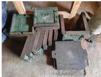
Gambar 3. 10 Cetakan Kubus (Sumber : Dokumentasi Penulis)
