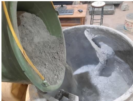
Gambar 3. 40 Memasukkan Semen ke dalam Concrete Mixer (Sumber : Dokumentasi Penulis)
