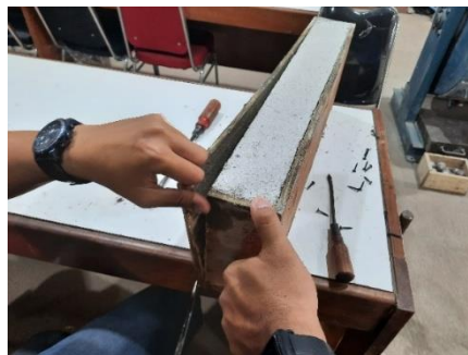
Gambar 3. 48 Pelepasan cetakan Bata Ringan (Sumber : Dokumentasi Penulis)
