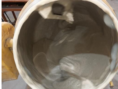
Gambar 3. 45 Mengaduk adonan Bata RIngan (Sumber : Dokumentasi Penulis)
