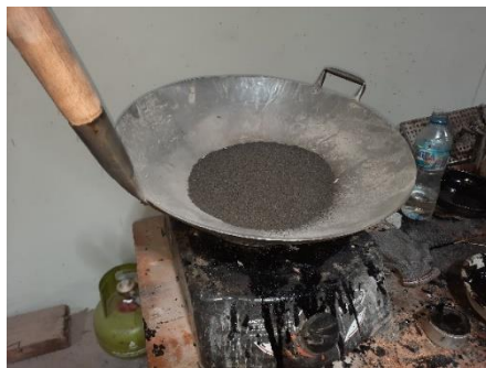
Gambar 3. 28 Mengeringkan Abu Vulkanik dengan Kompor (Sumber : Dokumentasi Penulis)
