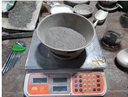
Gambar 3. 33 Proses menimbang Pasir sesuai kebutuhan (Sumber : Dokumentasi Penulis)
