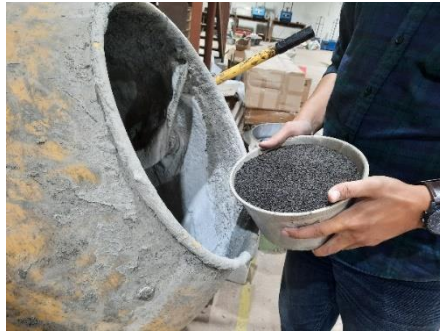
Gambar 3. 42 Memasukkan Abu Vulkanik ke dalam Concrete Mixer (Sumber : Dokumentasi Penulis)
