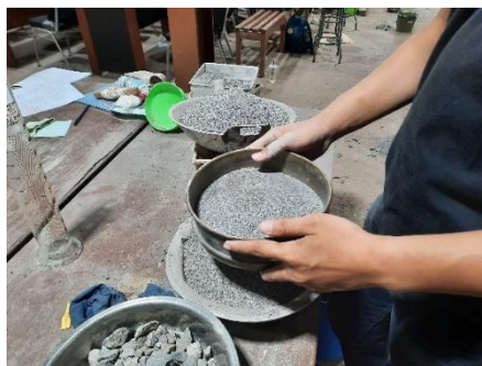
Gambar 3. 32 Proses Mengayak Pasir (Sumber : Dokumentasi Penulis)
