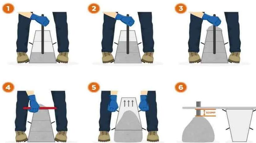
**Gambar 3. 3** Kerucut Abrams Sumber : *Jenis Slump Beton dan Kerucut Abram untuk Pengujian Nilai Slump Rencana*
