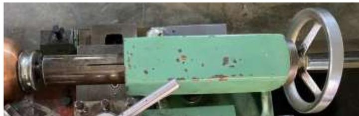
**Gambar 4.6.** Gambar setelah peletakkan clamp pada tailstock
