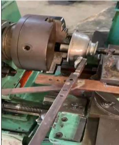
**Gambar 3.28.** Gambar assembly alat pada mesin bubut
