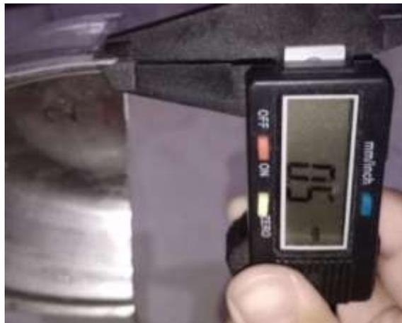
**Gambar 3. 29.** Gambar pengujian ketebalan akhir
