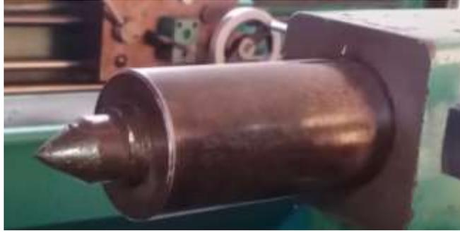
**Gambar 2.20.** Penjepit pada metal spinning
