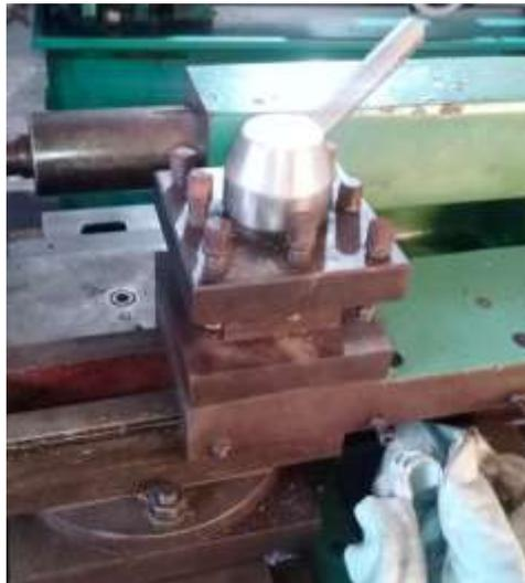
**Gambar 4.3.** Gambar sebelum peletakan set penekan pada rumah pahat
