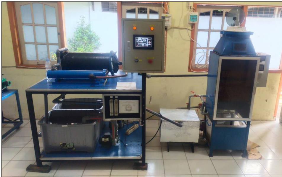
Gambar 4. 1 Hasil modifikasi testbed heat exchanger (Sumber: Dokumen pribadi)
