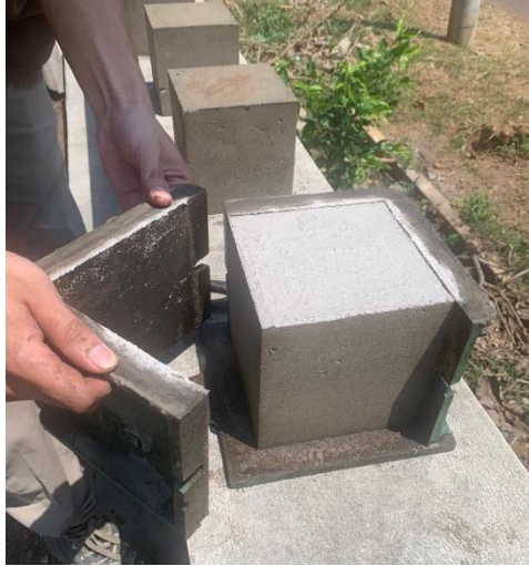
Gambar 3. 40 Proses Pembongkaran Cetakan Benda Uji
