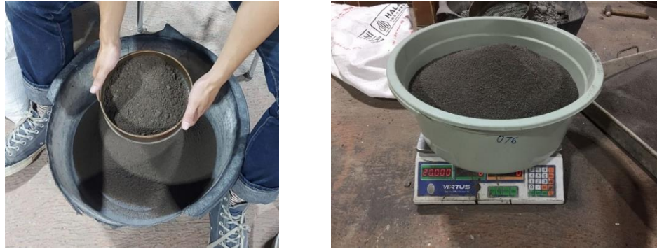
Gambar 3. 28 Pengayakan Pasir dan Penimbangan Pasir
