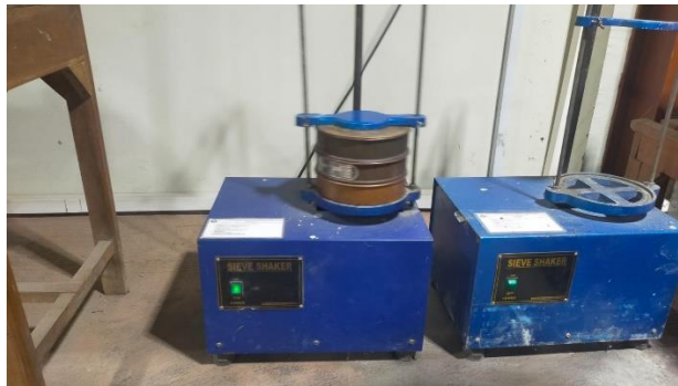
Gambar 3. 26 Pengayaan Serbuk Tiram dengan Sieve Shaker
