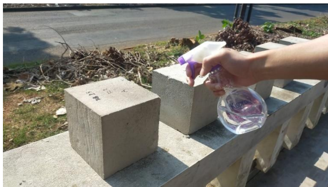
Gambar 3. 41 Perawatan Benda Uji
